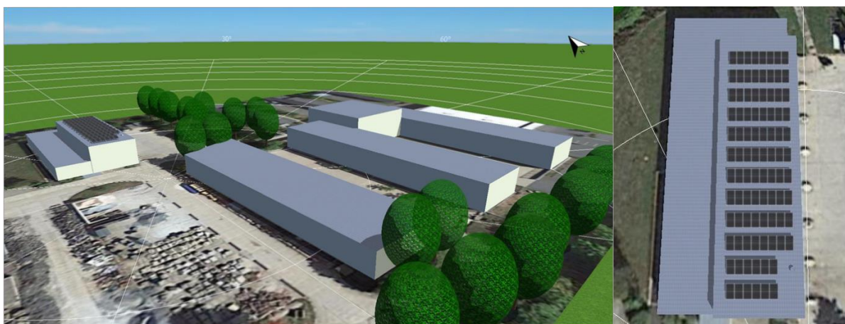
Abbildung 60: Dachbelegung Variante1 Gebäude Nr. 5
