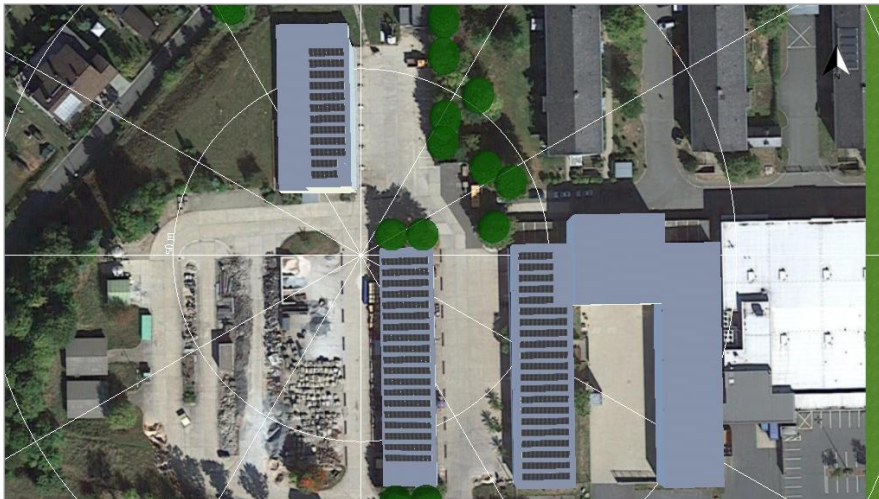
Abbildung 72: Dachbelegung Variante 5 Gebäude Nr. 5+5a+Lagerhalle
