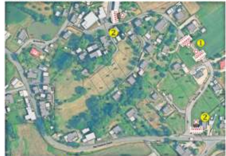
1 Absperrung mit Abzweiggleis u. VZ 216. 2 Absperrung mit Abzweiggleis u. VZ 216 sowie Zusatzschienen, Anlage für die Busse (VZ 204) und keine Weichenplan (VZ 188-34)
