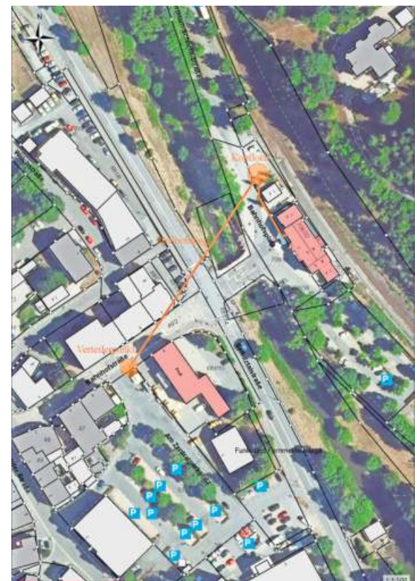
Trassenverlauf der Spülbohrung unter der Selbitz hindurch
